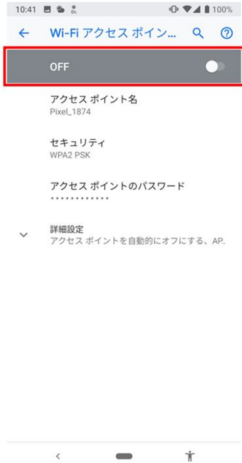
スライドボタンのタップでWi-Fiテザリングのオン/オフを切り替える
