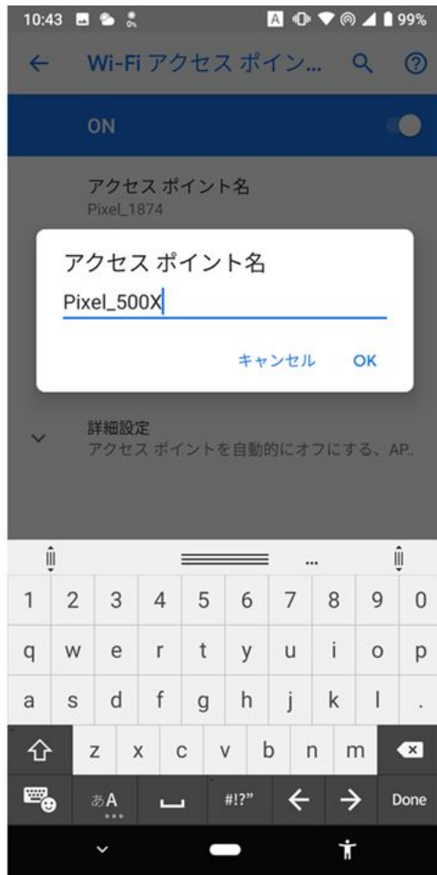
アクセスポイント名は自由に変更できる。自分の名前などを全角文字で設定しても認識する。変更したら「OK」をタップ
